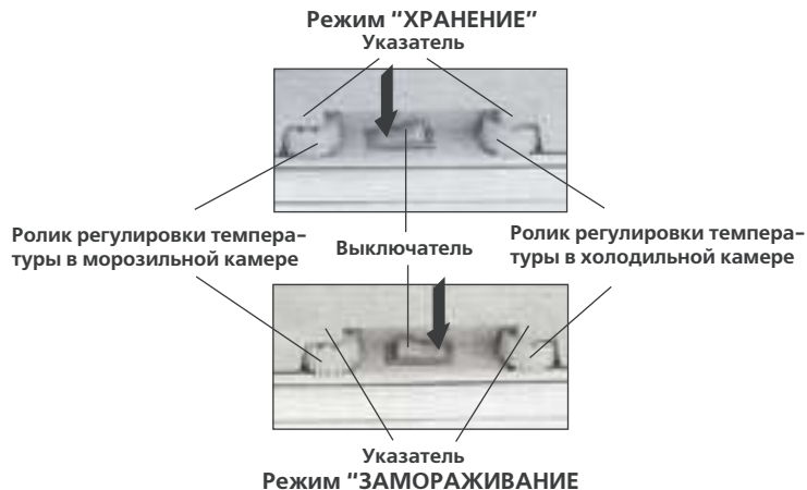
Рисунок 4 — Схема переключения режимов
