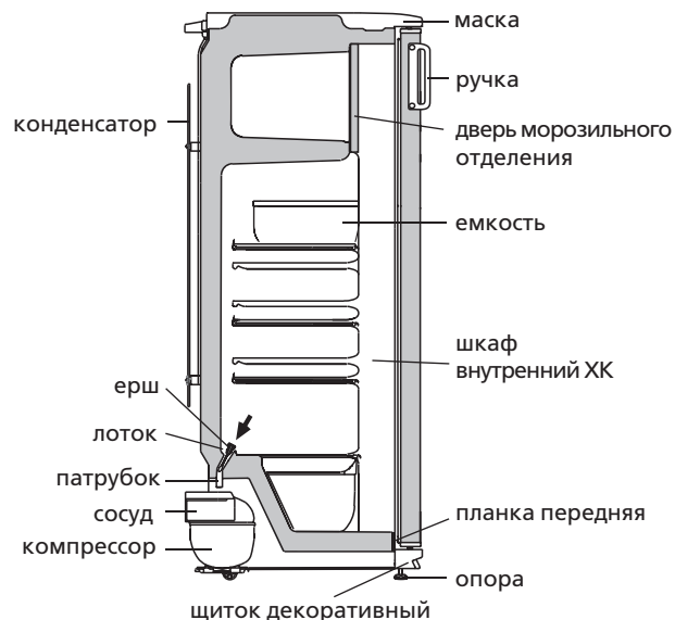
Рисунок 4 — Схема слива талой воды из ХК
